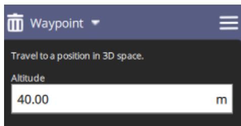
添加一个盘旋爬高航点，爬升到目标高度进入正常任务航线。
