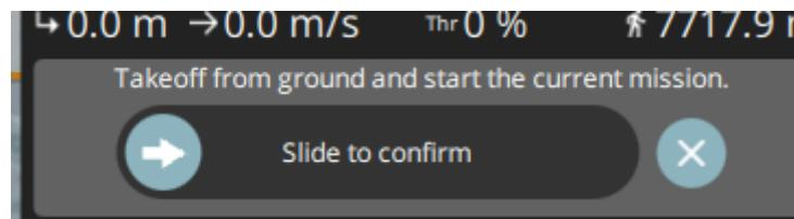
无人机自动解锁爬升到指定高度后，转换成固定翼巡航，无须人工介入操作，但操作员应保持警惕监控飞机状态。
