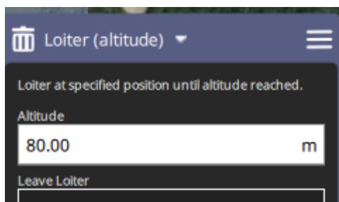
最后在降落点附近的区域放置一个无人机转换点，高度设置为较低的值。
