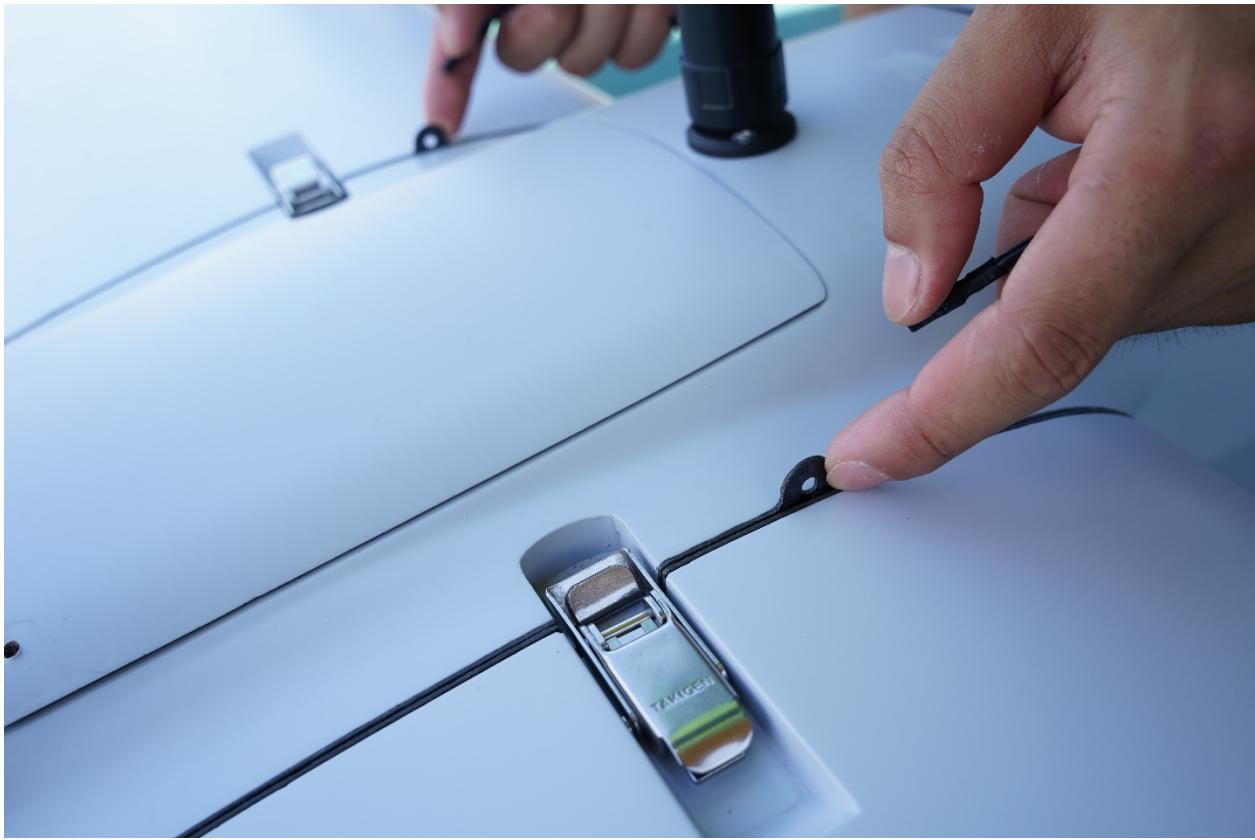
使用绳索将飞机平衡拉起进行重心测量。可通过调整电池的摆放位置，前后调整中心。当从重心测量点拉起时，前后保持平衡或机头轻微浮起，则调整成功。
