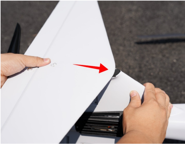
拉动快拆拉杆球头，使其突出卡槽，将其装入球头中。
