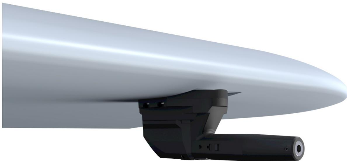
**注：螺旋桨转动会引起气流扰动，使无人机获得错误的空速数据，禁止将空速计安装于螺旋桨附近。**
